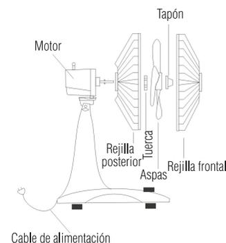
Para activar la oscilación, presione la perilla en la carcasa del motor.
