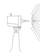
Coloque la rejilla trasera en el eje del motor y asegúrela con la tuerca protectora.
