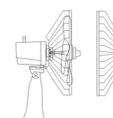
Coloque la rejilla frontal en la rejilla trasera y cierre los clips o atornille el anillo de la rejilla para asegurar las rejillas juntas
