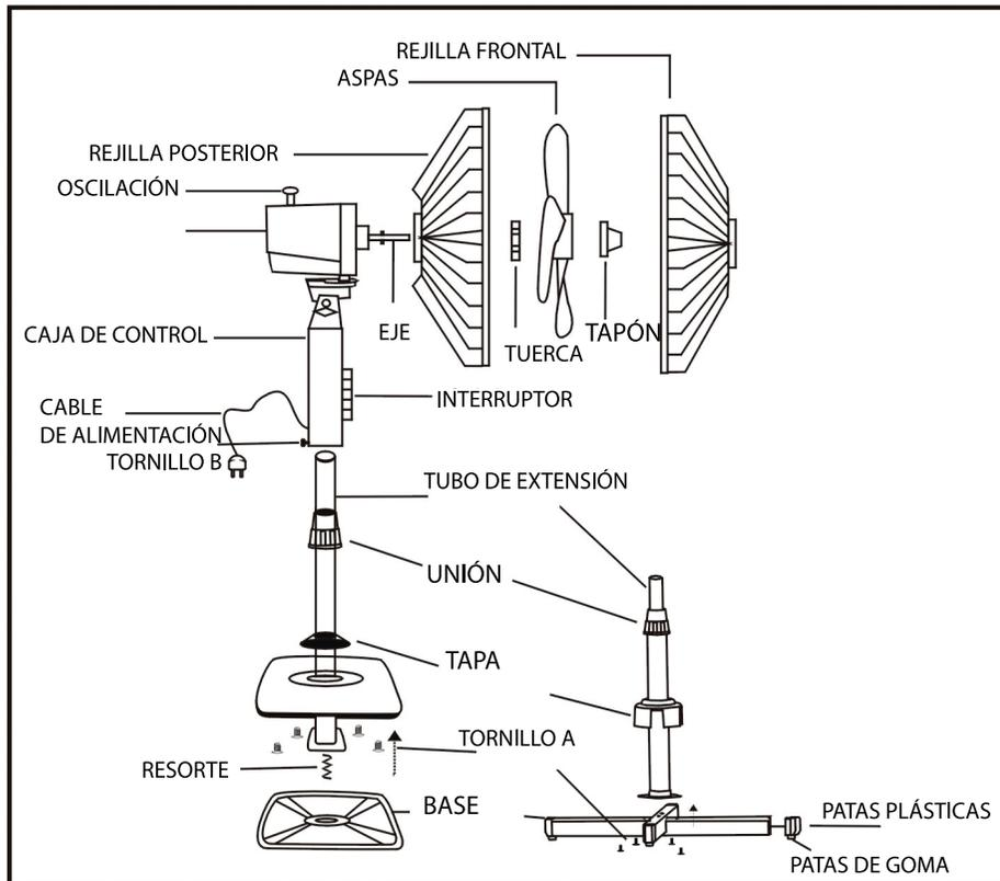
1. Coloque el resorte en el tubo desde la parte inferior, apriete el tubo a la base con el tornillo A.
