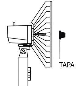
Coloque la rejilla posterior en el motor y asegure con la tuerca.
